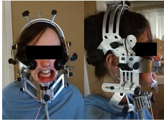
FIGURE 2 : Dispositif expérimental avec l'écarteur de lèvres, l'accéléromètre, et un casque de stabilisation relié à la sonde échographique
